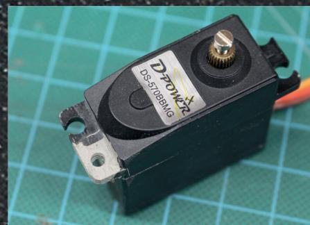
Nach etwa zwei Stunden Aushärtezeit ist die Masse fest und kann bearbeitet werden, eine leichte Wärmezufuhr beschleunigt den Aushärtevorgang. In diesem Fall habe ich die Masse zuerst auf Form gefeilt und anschließend das Befestigungsloch gebohrt.
