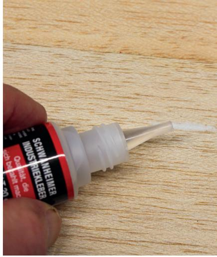
... und mit dem Industriekleber benetzen. Der Füllstoff härtet sofort aus und kann anschließend bearbeitet werden. In diesem Fall ist Schleifen angesagt.
