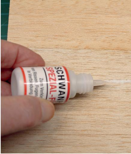
Der Füllstoff eignet sich auch, um Risse im Holz zu flicken. Dazu mit dem Füllstoff den Riss auffüllen...
