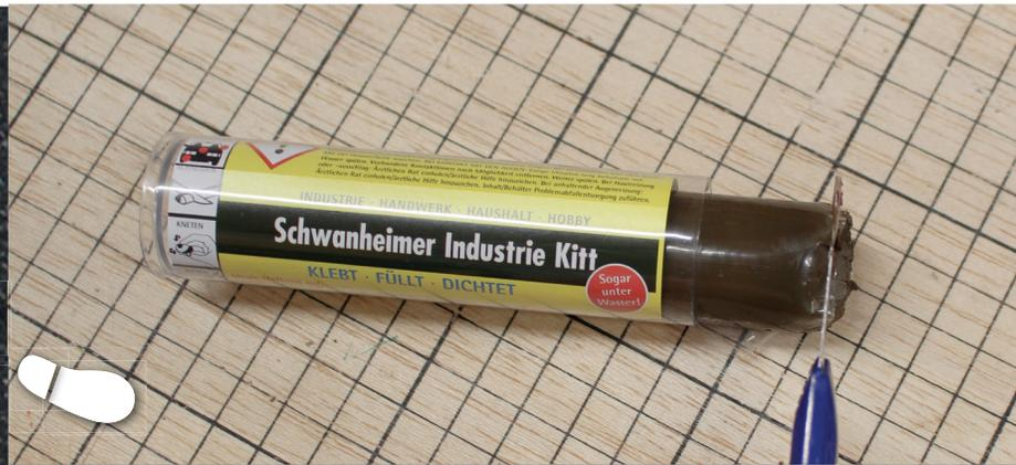
Um das fehlende Teil nachbauen zu können, wird ein kleines Stück von der Stange des Industrie-Kitts abgeschnitten. Diese „Wurst“ ist zweilagig – im Innern befindet sich das Harz und außen herum der Härter.
