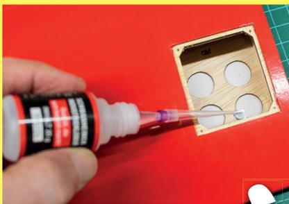
▲ Zunächst wird der Magnet des Deckels auf das bereits eingeklebte Eisenplättchen aufgesetzt. Der Magnet wird nun mit einem kleinen Tropfen Industriekleber benetzt. Die aufgesetzte Dosierspritze erleichtert das punktgenaue Aufbringen des Klebers.
