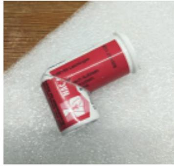
Das aus Tablettenröhrchen hergestellte Winkelstück ist von innen mit dem Spezialfüllstoff gefüllt.
