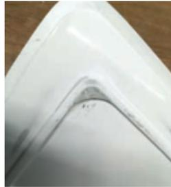
Nach dem Aushärten des Spezialfüllers mit dem Kleber entsteht eine sehr scharfe und harte neue Kontur.
