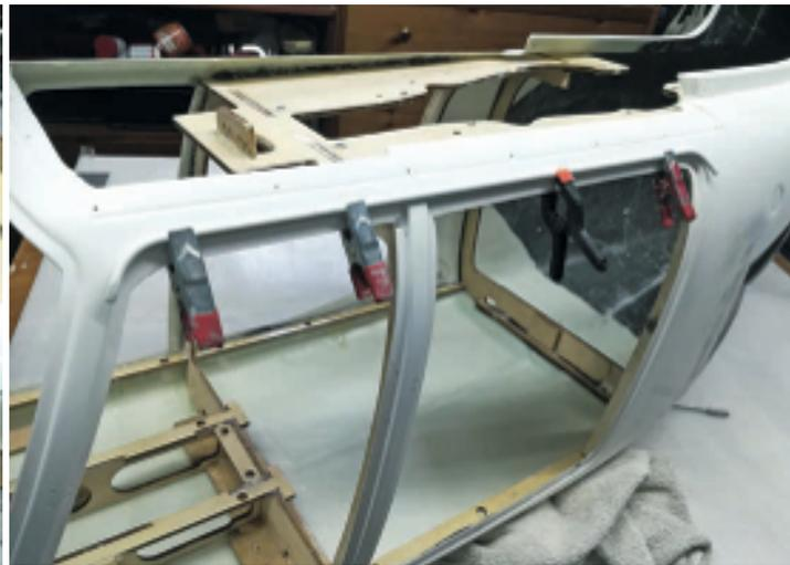
Die mit Aktivator vorbereitete Leiste kann nun, ohne dass der Kleber bereits aufgetragen ist, auf dem Modell ausgerichtet und mit Klammern fixiert werden. Erst dann wurde der extrem niedrigviskose Schwanheimer 100 mit der mitgelieferten Mikrodosierspitze von oben in die Kehlung aufgetragen.
