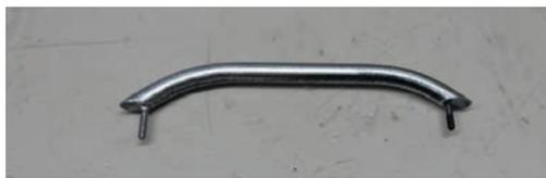
Dadurch, dass das so entstandene Kniestück von innen aufgefüllt ist, konnte ich den Außenbogen abrunden, ohne Gefahr zu laufen, die Verklebung zu schwächen oder gar durchzuschleifen. Auch das Befestigen diverser Kleinteile in dafür zu großen Öffnungen ist mit dem Spezialfüllstoff problemlos möglich.
