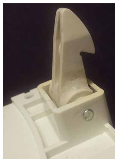
Bei Teilen mit kleiner Klebefläche sorgt der Füllstoff für zusätzliche Stabilität
